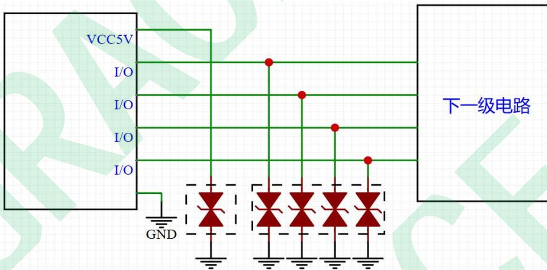
在 I/O 接口推荐选择可锐聚合物静电抑制器系列产品 KESD0603ED5R0C0R05□□T, 在保证信号完整性的同时，通过静电测试。
